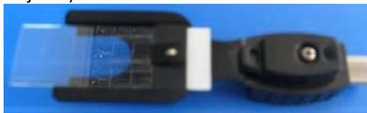
4. Abra el soporte cargado presionándolo en el extremo exterior. Deslice el portaobjetos en el soporte y suelte el resorte.
