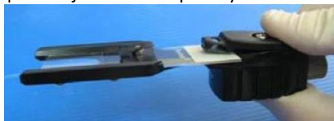
5. Alinee el extremo del portaobjetos con el extremo distal del adaptador del portaobjetos girando el ajustador como se observa más adelante. El portaobjetos estará ahora firmemente colocado en el adaptador:
