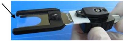
6. Inserte el adaptador de portaobjetos cargado totalmente en la cámara de visualización de SQA-V.
