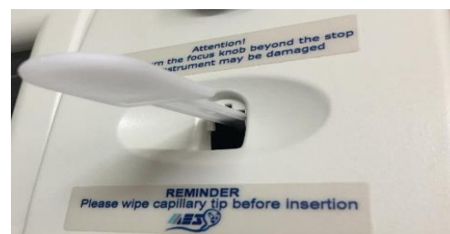
图 5: 纤维材料面朝下插入光电测量仓
