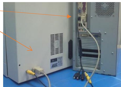
通信ケーブル接続
