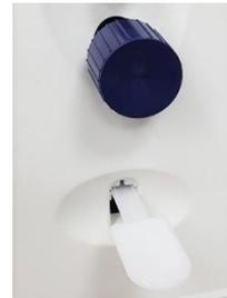
图 5：纤维材料面朝下插入光电测量仓
