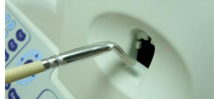
Abbildung 2: Reinigung der unteren Kammer
