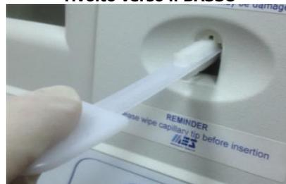
Figura 6 Inserimento della **spatola di asciugatura**
