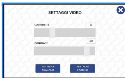
Utilizzare **SETTAGGI AVANZATI** per la regolazione fine e **SETTAGGI FABBRIC** per ripristinare le impostazioni predefinite del video utilizzando i tre pulsanti nell'angolo in basso a destra:
