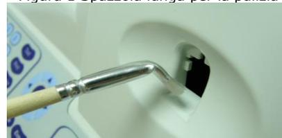
Figura 2 Pulizia della camera inferiore
