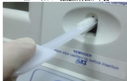
図 6：乾燥用パドルの挿入
