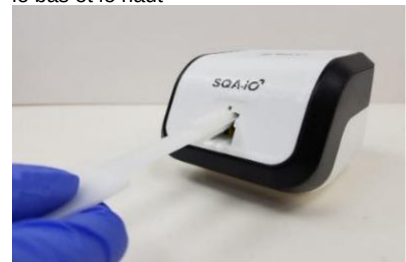
Fig. 6 Séchez la chambre d'essai avec l'éponge
