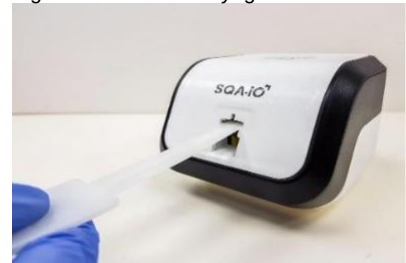
Fig. 5 Insérez la palette de nettoyage vers le bas et le haut
