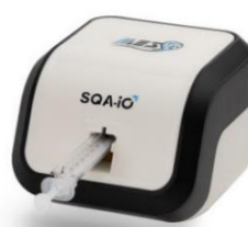
Fig. 5: Inserir o capilar no SQA-iO
