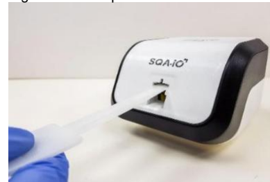
Fig. 5 Inserir a pá de limpeza para baixo e para cima
