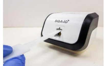
Şekil 5. Temizleme fırçasını aşağı ve yukarı yerleştirin
