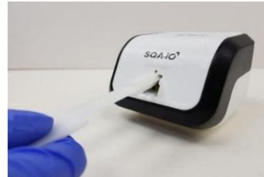
Abb. 6 Trocknen der Messkammer mit dem Schwamm
