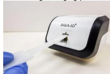
Abb. 5 Reinigungspaddel nach unten und oben einführen
