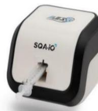
Abb. 5: Die Kapillare in den SQA-iO einführen
