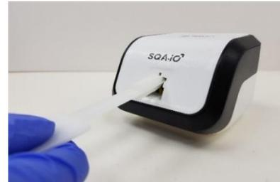
Abb. 6 Trocknen der Testkammer mit dem Schwamm
