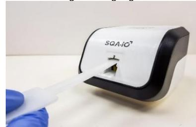
Abb. 5 Reinigungspaddel nach unten und oben einsetzen
