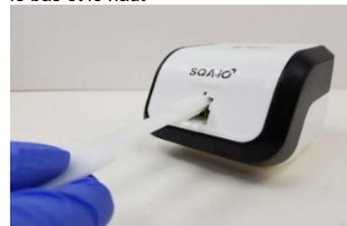
Fig. 6 Séchez la chambre d'essai avec l'éponge
