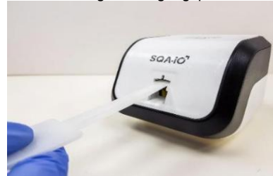
Abb. 5 Reinigungspaddel nach unten und oben einführen
