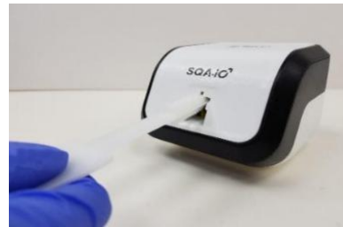
Abb. 6 Trocknen der Messkammer mit dem Schwamm
