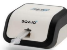
Εικ. 5: Τοποθετήστε το σωληνάριο μέσα στη συσκευή SQA-iO
