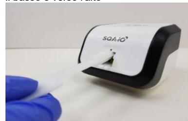
Fig. 6 Asciugare la camera di prova con la spugna
