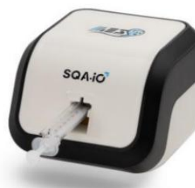
Fig. 5: Insira o capilar no SQA-iO
