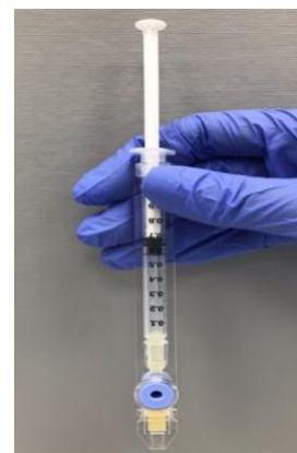
Fig. 2: Inspeção de bolhas de ar
