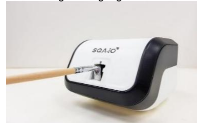
Abb. 2 Reinigung der Kammer
