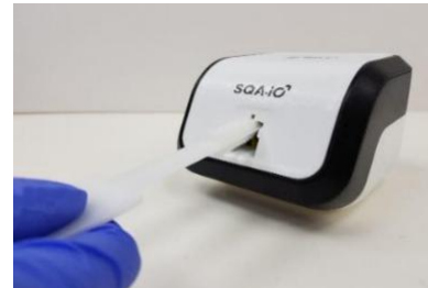
Abb. 6 Trocknen der Messkammer mit dem Schwamm
