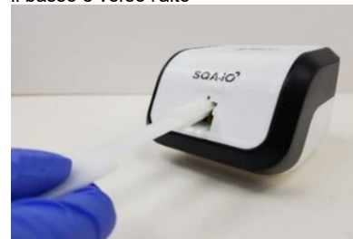
Fig. 6 Asciugare la camera di prova con la spugna
