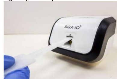
Fig. 5 Inserire la spatola per la pulizia verso il basso e verso l'alto
