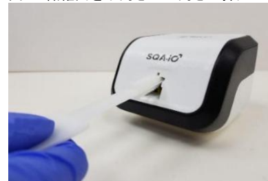
図6 スポンジでテストチャンバーを乾燥
