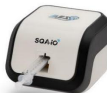
Fig. 5: Insira o capilar no SQA-iO
