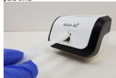
Fig. 6 Secar a câmara de teste com esponja
