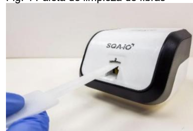
Fig. 5 Inserte la paleta de limpieza boca abajo y boca arriba
